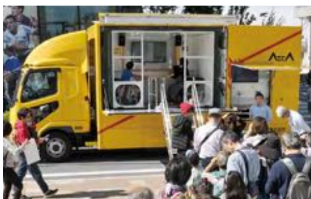
OS-14 飛鳥特装株式会社 地震体験（3次元起震装置搭載地震体験車）
