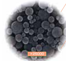
無孔質セラミックの顕微鏡写真
