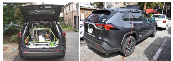
写真-4 車載の様子と車載コンセントからの給電
