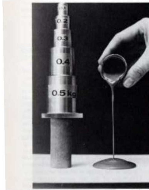
図 6 クイッククレイのチキソトロピックな流動性。練り返す前は強度を持った円柱試料(左)。練り返すと流動性液体に変わる(右)。(Mitchell ; 1976 より)
